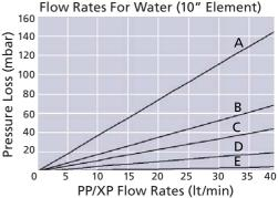
A=0.5μm B=1μm C=3/5μm D=XP/10-50μm E=70/90μm
